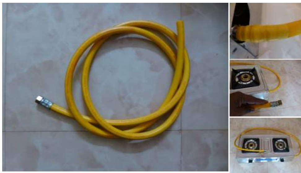
شکل ۸- اتصال شلنگ گاز به اجاق گاز
