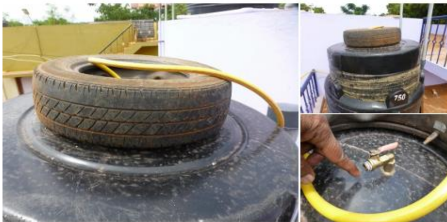
شکل ۹- اضافه کردن وزنه تعادل در بالای مخزن نگهدارنده گاز برای جلوگیری از برگشت جریان
