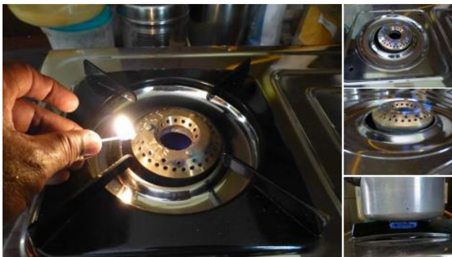
شکل ۱۰- آزمایش و روشن کردن اجاق گاز خانگی با بیوگاز
