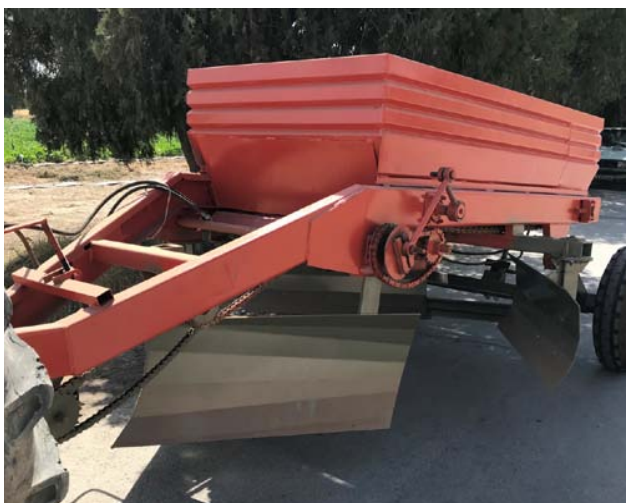
شکل ۴- کارنده ویژه مزارع بنه بذری زعفران
