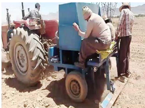
شکل ۲- پیاز کار شش ردیفه نیمه خودکار
