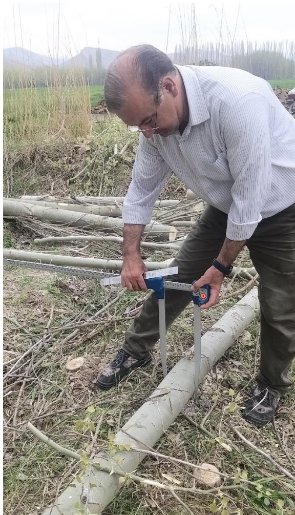
شکل ۲- اندازه‌گیری قطر درختان صنوبر قطع شده بر روی زمین با استفاده از خط‌کش دوبازو
