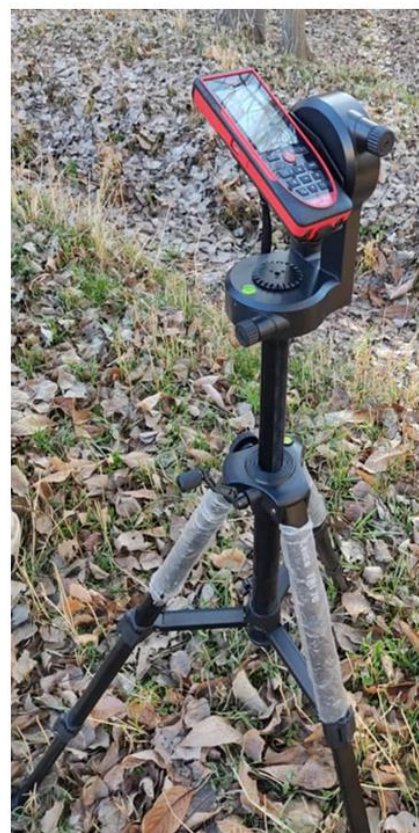
شکل ۳- نحوه استقرار دستگاه لایکا بر روی سه‌پایه در توده صنوبرکاری شکل ۴- برخورد نور لیزر دستگاه لایکا به تنه درخت صنوبر برای اندازه‌گیری شکل ۵- اندازه‌گیری قطر در ارتفاع بالاتر از برابرسینه تنه درخت صنوبر قطر
