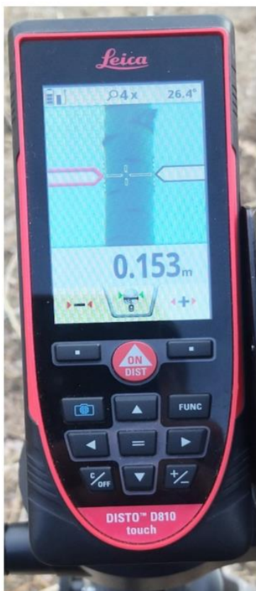
شکل ۳- نحوه استقرار دستگاه لایکا بر روی سه‌پایه در توده صنوبرکاری شکل ۴- برخورد نور لیزر دستگاه لایکا به تنه درخت صنوبر برای اندازه‌گیری شکل ۵- اندازه‌گیری قطر در ارتفاع بالاتر از برابرسینه تنه درخت صنوبر قطر
