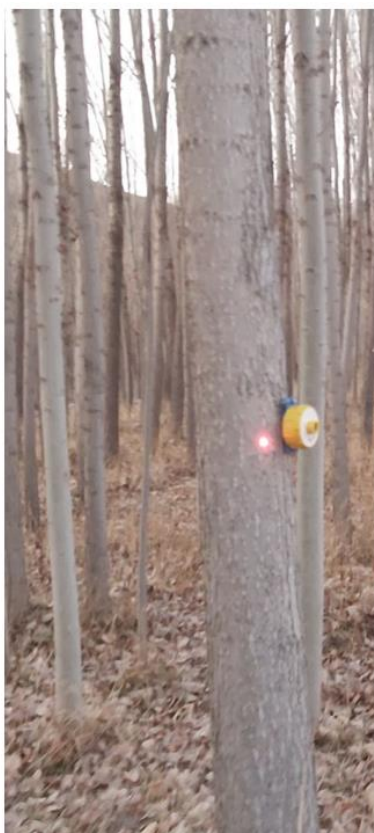
شکل ۳- نحوه استقرار دستگاه لایکا بر روی سه‌پایه در توده صنوبرکاری شکل ۴- برخورد نور لیزر دستگاه لایکا به تنه درخت صنوبر برای اندازه‌گیری شکل ۵- اندازه‌گیری قطر در ارتفاع بالاتر از برابرسینه تنه درخت صنوبر قطر
