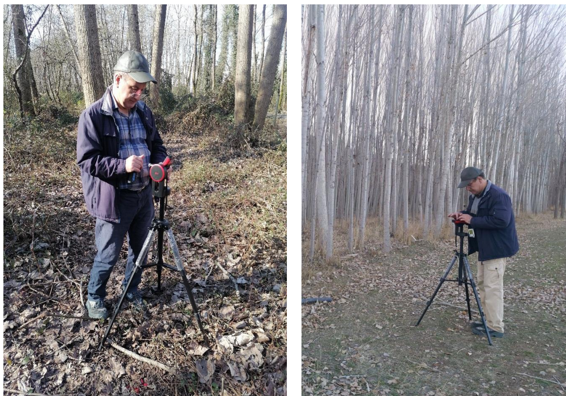
شکل ۱- اندازه‌گیری قطر در ارتفاعات مختلف تنه درختان صنوبر با استفاده از دستگاه لیزری لایکا
