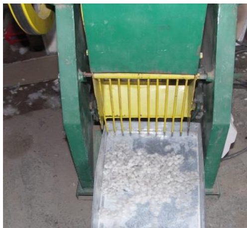
شکل ۵- استفاده از سطح شیب‌دار برای کاهش صدمه مکانیکی به بذر گُرک‌دار پنبه در زمان خروج از ماشین جین
