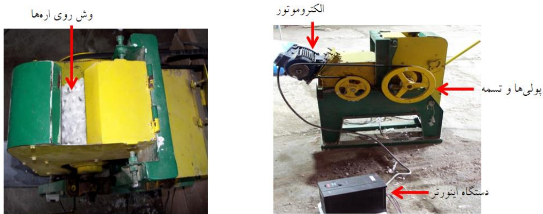
شکل ۳- ماشین جین اره‌ای (راست) و جداسازی وش به وسیله اره‌ها (چپ)
