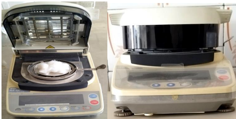
شکل ۴- دستگاه رطوبت‌سنج (راست) و محل قرارگیری وش برای تعیین رطوبت (چپ)
