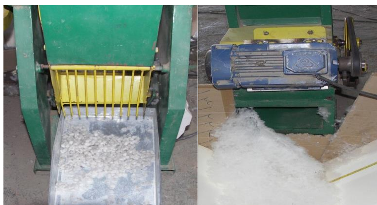
شکل ۲- خروج الیاف از قسمت عقب ماشین جین اره‌ای (راست) و بذر گُرک‌دار پنبه از قسمت جلو (چپ)
