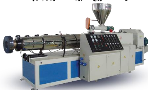
شکل ۳- دستگاه تولید لوله تیپ
