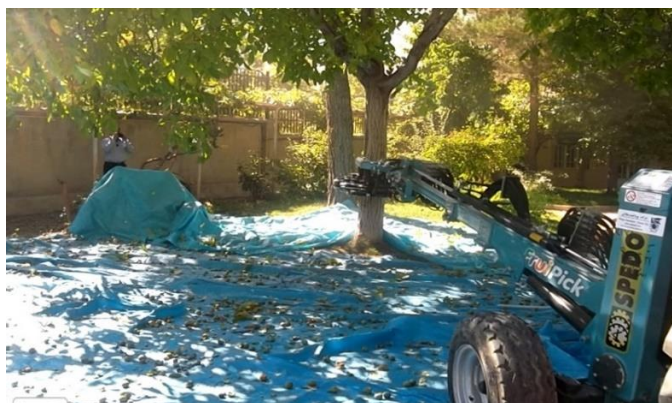
شکل ۳- برداشت مکانیزه گردو با تکان‌دهنده تنه
