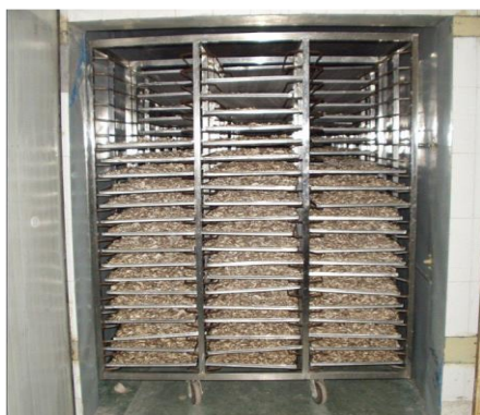
شکل ۹- خشک‌کن بستر ثابت (راست) و خشک‌کن تونلی (چپ) برای خشک‌کردن گردو
