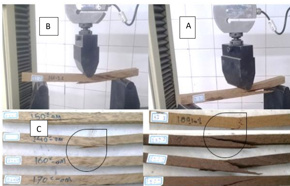
شکل ۴- آزمون مقاومت خمشی قبل (A) و بعد از اصلاح حرارتی (B) و نمونه‌های نخل در دماهای مختلف (C)
