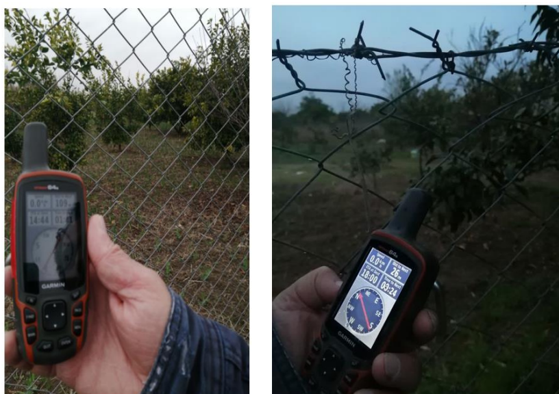
شکل ۶- راستی آزمایی کارایی و دقت ماشین ابداعی پردازشگر تصویر با بازیابی تعدادی نقطه تصادفی استخراج شده از نقشه مرکبات تولید شده در زمین
