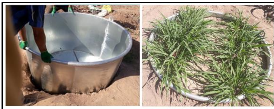
شکل ۲- لایسیمتر مورد استفاده در محل اجرای آزمایش
