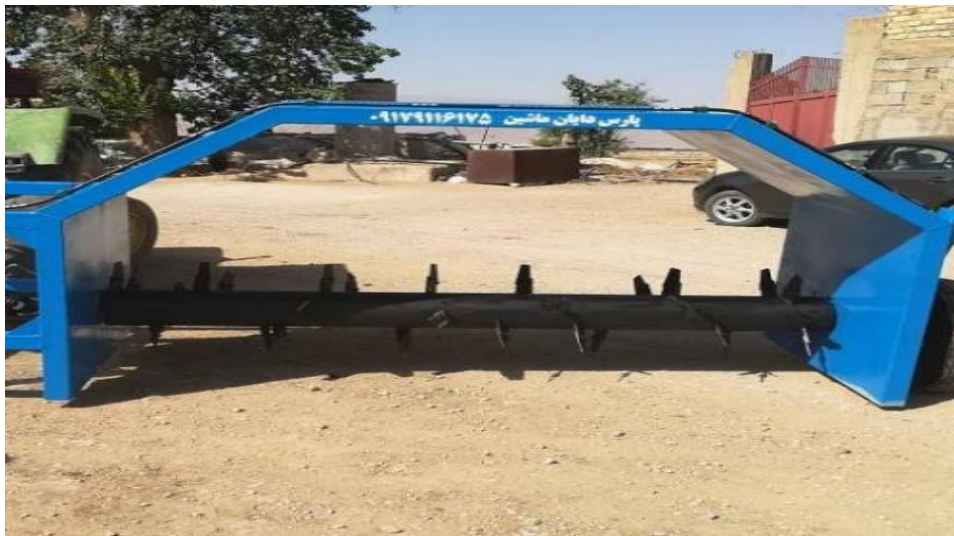
شکل ۵- ترنر مورد استفاده در تولید بیوکمپوست
