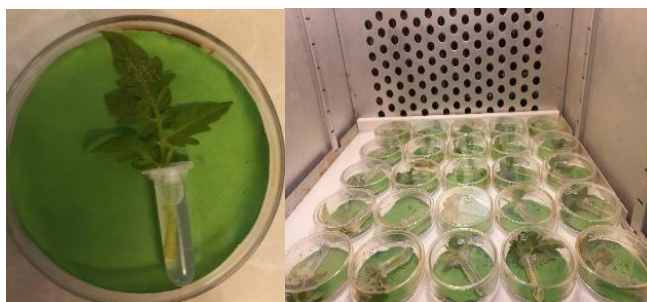
شکل ۳- ظروف پتری شیشه‌ای برای آزمایش‌های شکارگری سن Nesidiocoris tenuis (اصلی).
