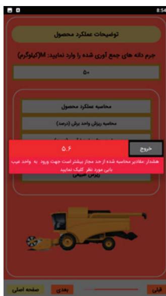
شکل ۲- هشدار زیاد بودن مقدار ریزش کمباین
