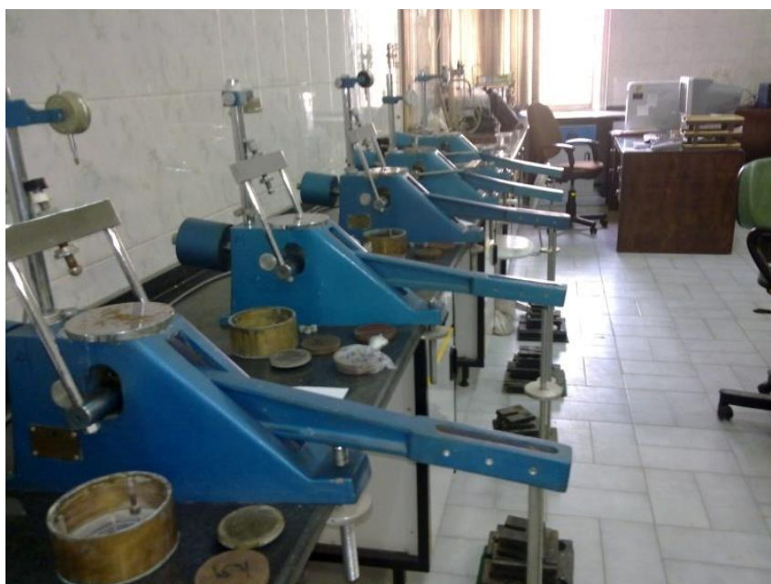
شکل ۵- تصویری از دستگاه های تحکیم مورد استفاده
