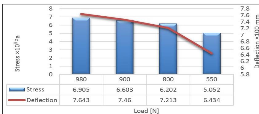
شکل ۳۰- تنش و تغییرمکان‌های بیشینه به‌وجود آمده در توری ناشی از بارگذاری‌های مختلف روی پوشش راهرو سایبان با چینش فاصله ستون ۴×۵ متر
