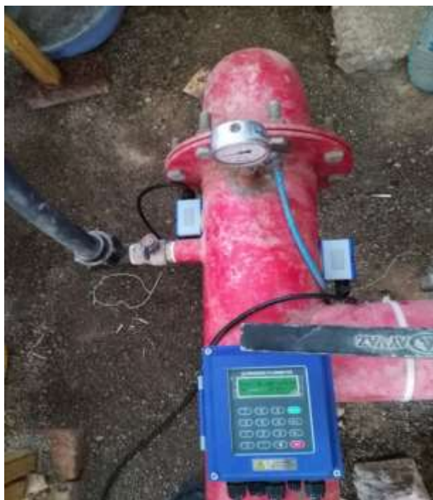
شکل ۱- پایش دبی لحظه‌ای در ورودی ایستگاه کنترل مرکزی با استفاده از دبی‌سنج اولتراسونیک (مزرعه آبیاری زیرسطحی یونجه، بوئین‌زهرآ)
