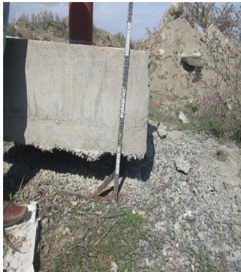
شکل ۸- فرونشست مشاهده‌ای در دشت سلماس (تاریخ ۱۴۰۲/۴/۴) Fig. 8. Observed subsidence in Salmas plain (Date: 25 June, 2023)
