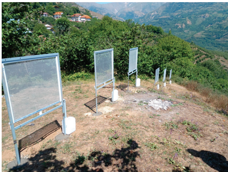
شکل ۳- سامانه‌های نصب شده به منظور جمع‌آوری آب از مه در باغ فندق
