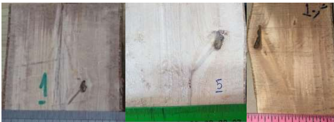
شکل ۶- ویژگی نشانگر درونی ساقه‌های دارای گره‌های بزرگ (راست)، متوسط (وسط) و کوچک (چپ) پس از برش شعاعی Figure 6. Internal indicator feature of stems with large (right), medium (middle), and small (left) knots after radial cutting
