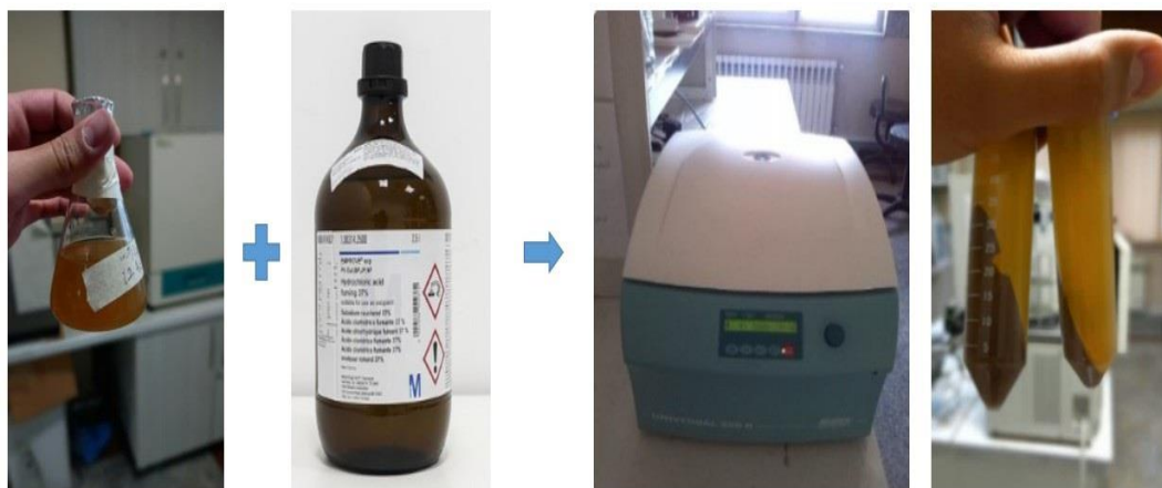
شکل ۴- مراحل جداسازی کاروتنوپروتئین با دستگاه سانتریفیوژ
