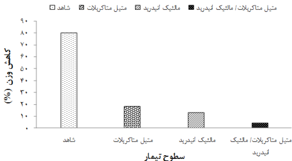
شکل ۵- اثر اصلاح با مالئیک انیدرید و متیل متاکریلات بر کاهش وزن نمونه‌ها در برابر قارچ پوسیدگی سفید
