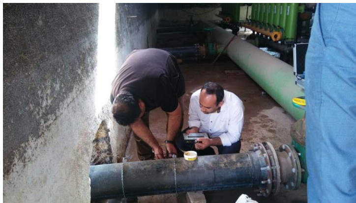
شکل ۱- پایش دبی لحظه‌ای در محل ورودی ایستگاه کنترل مرکزی با استفاده از دبی‌سنج اولتراسونیک
