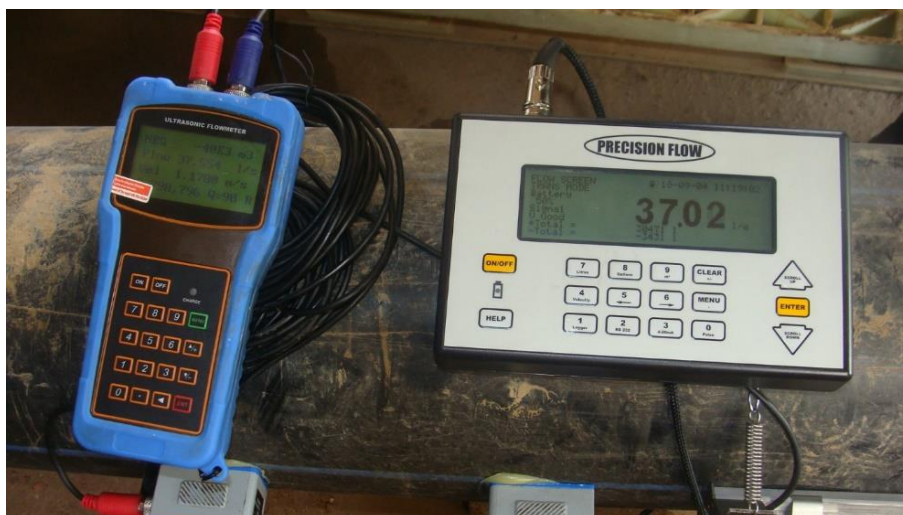
شکل ۲- پایش دبی لحظه‌ای در محل ایستگاه پمپاژ با استفاده از دبی سنج اولتراسونیک (مجتمع کشت و صنعت خندان)
