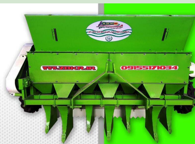
شکل ۲- دستگاه تمام اتوماتیک پیازکار زعفران ۷ ردیفه
