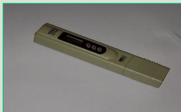
نگاره ۲- دستگاه اندازه‌گیری TDS و دمای محلول‌ها.
