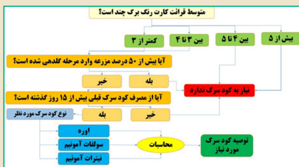
شکل ۴-فلوچارت تشخیص نیاز نیتروژنی گندم از طریق کارت رنگ برگ، مورد استفاده در ابلیکیشن (برنامه کاربردی)
