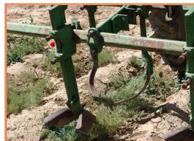
شکل ۲- مقایسه تیغه‌های مختلف کولتیواتور جلوی فاروئر در مزرعه سیب‌زمینی (عکس از نویسنده)
