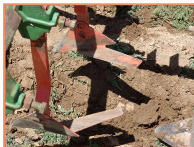
شکل ۲- مقایسه تیغه‌های مختلف کولتیواتور جلوی فاروئر در مزرعه سیب‌زمینی (عکس از نویسنده)
