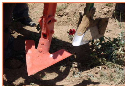
شکل ۲- مقایسه تیغه‌های مختلف کولتیواتور جلوی فاروئر در مزرعه سیب‌زمینی (عکس از نویسنده)
