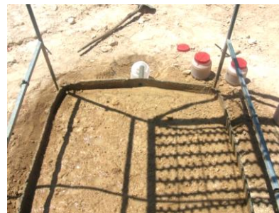
شکل ۲- پلات باران‌ساز، لوله و ظرف جمع‌آوری کننده آب و رسوب
