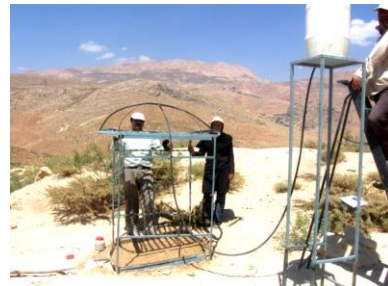
شکل ۱- نمایی از دستگاه باران‌ساز مصنوعی و اجزای آن
