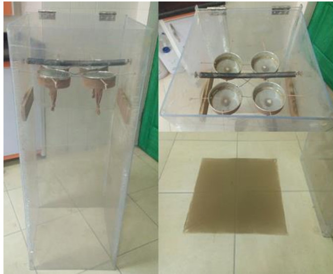
شکل ۱ اتافک گرد و خاک‌ساز مورد استفاده و نمایی از توزیع یکنواخت گرد و خاک بر روی سطح زمین
