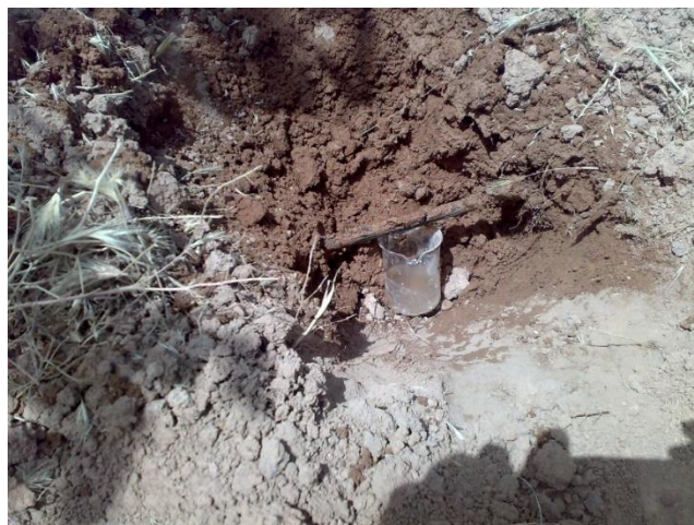
شکل ۲: اندازه‌گیری دبی خروجی قطره‌چکان (باغ محمودی)
