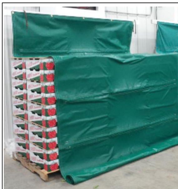
شکل ۸- سیستم هوای سرد فشرده برای سرد کردن توت‌فرنگی
