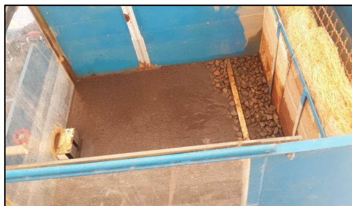
شکل ۲- تصویر واقعی مدل آزمایشگاهی مخزن به همراه اتاقک رسوب نصب شده مقابل دریچه تحتانی
