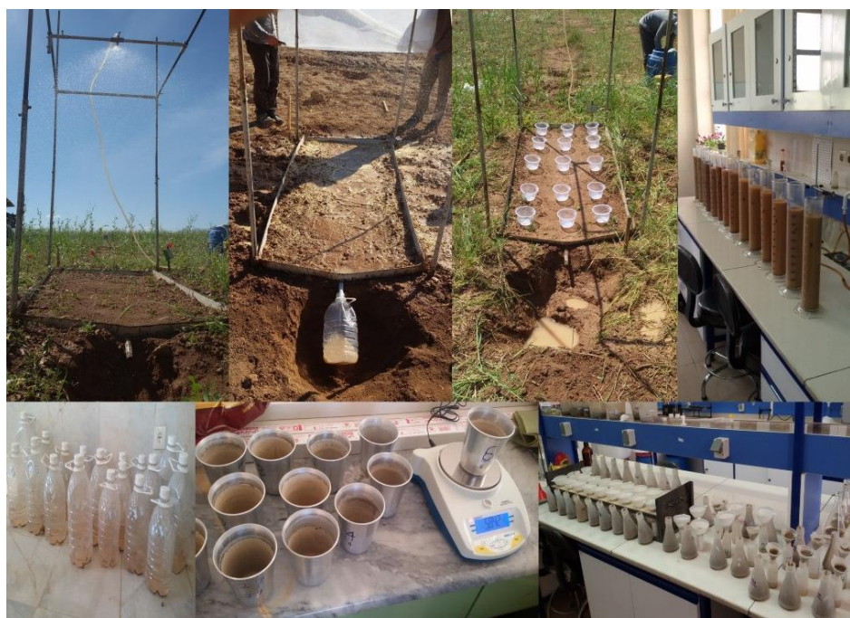
شکل ۲- مراحل شبیه‌سازی و اندازه‌گیری رواناب و رسوب.
