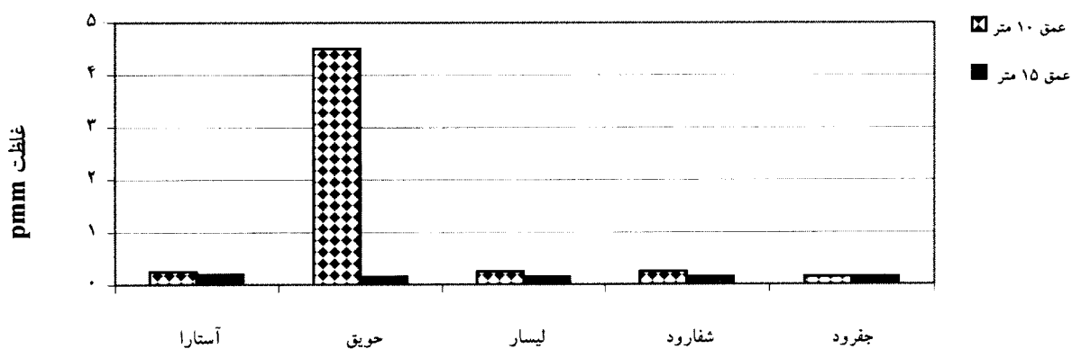
نمودار ۲: غلظت Zn در رسوبات اعماق ۱۰ و ۱۵ متری ۵ ایستگاه در بخش جنوب غربی دریای خزر (۱۳۸۰)
