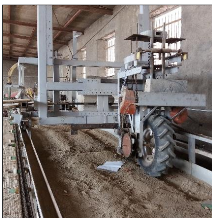
شکل ۲- نمایی از مجموعه انباره خاک و آزمونگر تک‌چرخ Fig. 2- Soil bin facility and single-wheel tester
