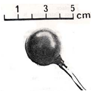
شکل ۵- مبدل انعطاف‌پذیر برای اندازه‌گیری فشار هیدرواستاتیک (Verma et al., 1976)
