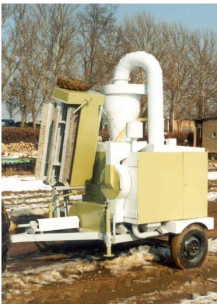
شکل 4- نحوه جمع شدن سکوی برداشت
