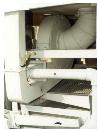
شکل 5- دمنده کمباین و کانال انتقال جریان
