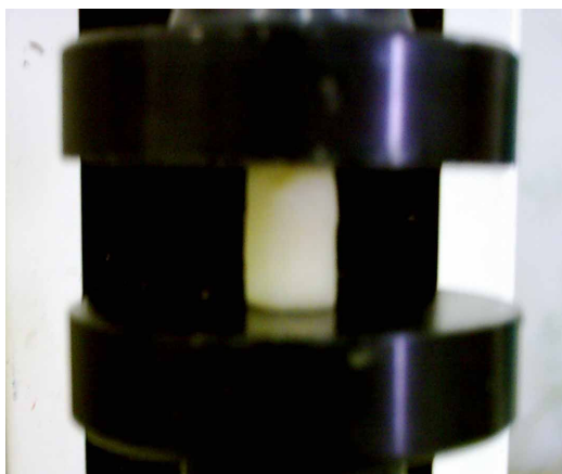
شکل شماره ۳- نمونه‌های استوانه‌ای تهیه شده از گوشت سیب، پس از نمونه‌گیری (راست) و در حین بارگذاری (چپ)
