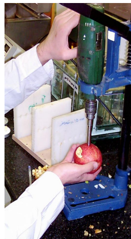
شکل شماره ۲- نمونه گیر استوانه‌ای سیب (چپ) و نحوه نمونه‌گیری (راست)
