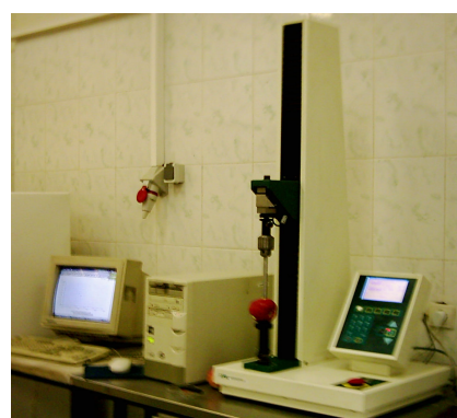
شکل شماره ۱- ماشین تست یونیورسال (راست)، آزمون نفوذسنجی (وسط) و موقعیتهای نمونه‌گیری روی هر سیب (چپ)
