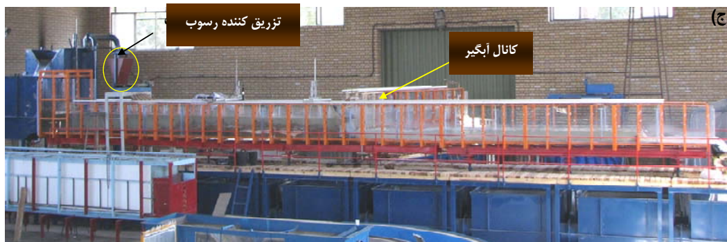
شکل ۱- (الف) نمای کلی از کانال آزمایشگاهی، (ب) مقطع A-A، شامل سرریز بند انحرافی، مجرای تخلیه رسوب و دهانه آبگیر و (ج) طرح کلی و نمایی از مدل آزمایشگاهی
