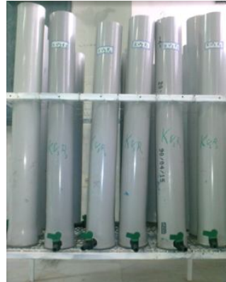
شکل 1- ستون‌های پلی‌اتیلنی مورد استفاده در این تحقیق
